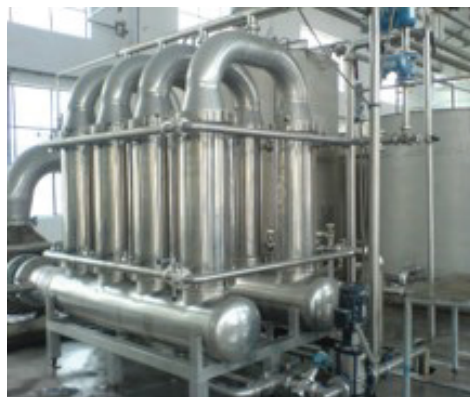
陶瓷膜中型試驗及生產設備 膜面積 6\text{m}^2
