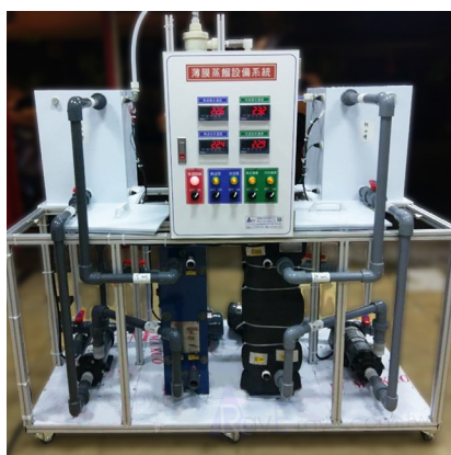
中型試驗設備 膜面積1m 2
