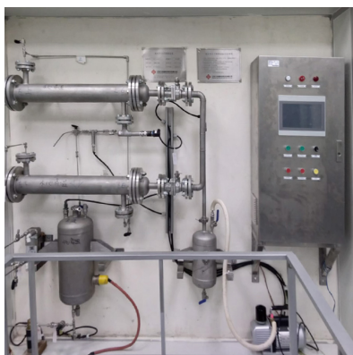
中型試驗設備 產量5.2kg/h
