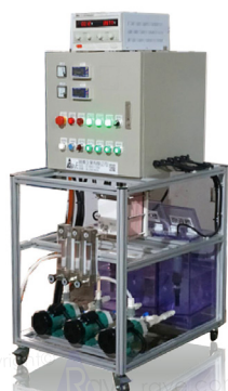
EDR小型實驗機 處理量30L/h
