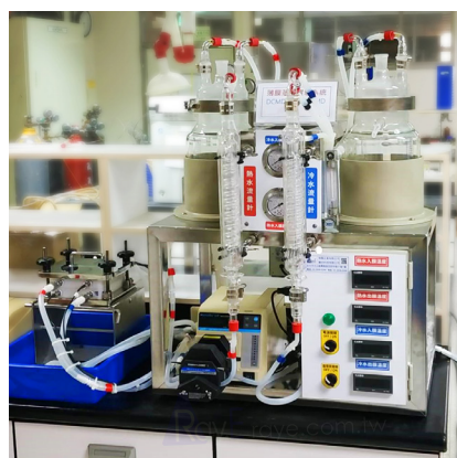
小型實驗機 膜面積0.01m 2
