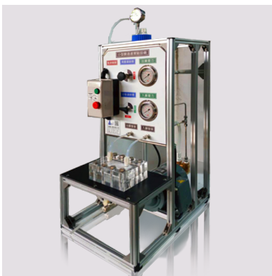
小型平板膜實驗機 膜面積0.01m 2
