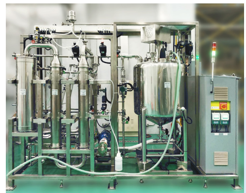
陶瓷膜大型量產設備 膜面積 36\text{m}^2
